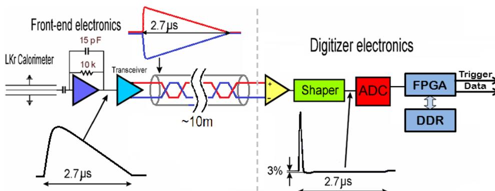
**Figure 3.** LKr readout chain.
